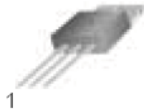
1. Input 2. GND 3. Output
